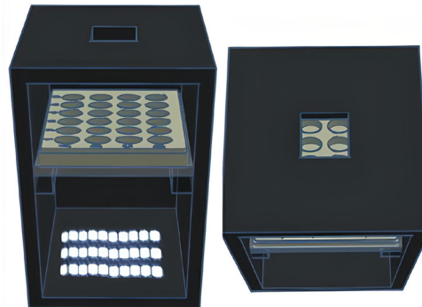
Figura 1. Aparato construído em MDF para captura das imagens em ambiente controlado. Na base, LEDs para iluminação; na parte superior, a microplaca de poços contendo as soluções a serem analisadas.
