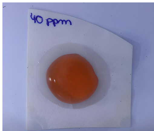
Figura 2. Dispositivo analítico na concentração de 40 \text{mg L}^{-1} em papel de filtro quantitativo, contendo o complexo [\text{Fe}(\text{SCN})_6]^{3+} .
