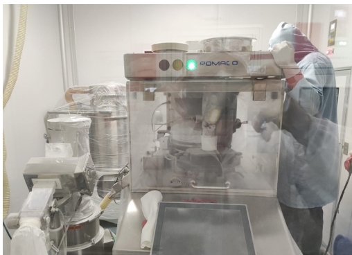
Figura 6: Sistema de enclausuramento e exaustão local nas máquinas. Fonte: Autores.
