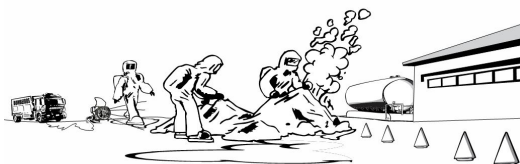
Figura 11: Utilização de lonas para reduzir uma liberação de amônia. Fonte: Do autor.
