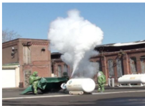
Figura 7: Comportamento da nuvem toxica após uma liberação de amônia. Fonte: Resposta de emergência de amônia TRANSCAER 2011.
