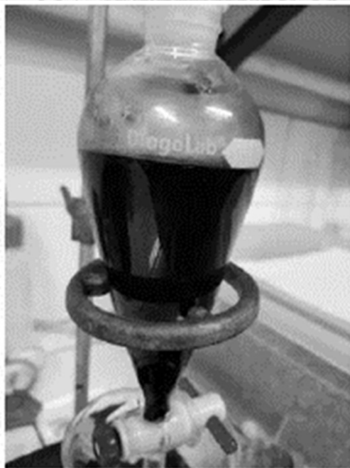
Figura 4. Carvão e Bio-Óleo obtidos do processo de pirólise.
