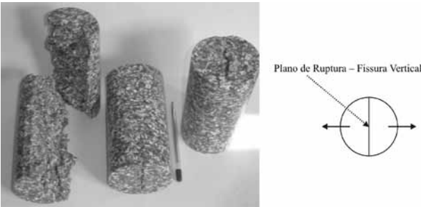
Figura 7: Tipo de Ruptura característica: Fissura vertical devido compressão diametral.
