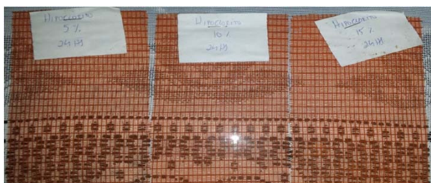
Figura 4. Telas tratadas com hipoclorito de sódio nas concentrações de 5; 10 e 15% com 24 horas de imersão.
