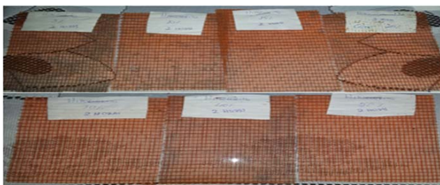
Figura 3. Telas tratadas com hipoclorito de sódio. Na parte superior, telas tratadas nas concentrações de 5; 10; 15 e 20%. Na parte inferior, as telas tratadas com 30; 40 e 50% v/v com duas horas de imersão.
